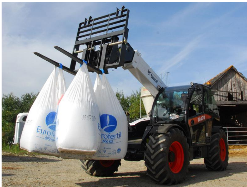
Rys. 6.4. Podnośnik teleskopowy Bobcat TL 470 transportujący materiały sypkie
