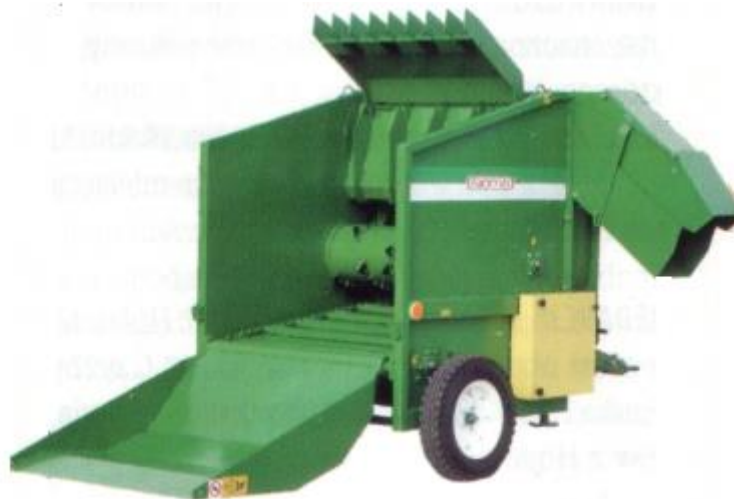
Rys. 6.18. Rozdrabniacz bel słomy i siana
