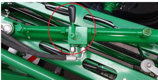
Rys. 25 Dźwignia zamka na siłowniku rozkładania ostatniego skrzydła.
