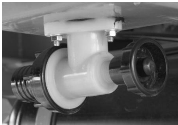
Rys. 17. Zawór spustowy zbiornika głównego
