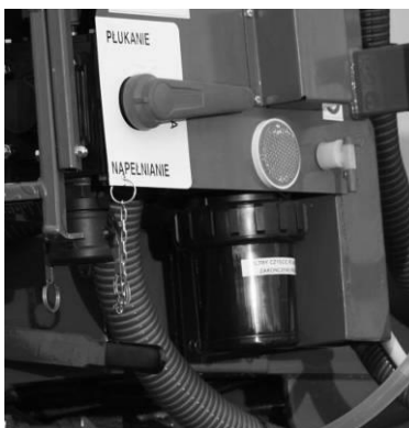
Rys. 12. Widok filtra ssawnego
