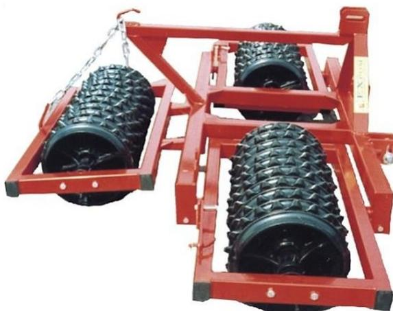
**Rys. 2.15 Zespół wałów pierścieniowych Cambridge firmy Expom sp. z o.o.**
