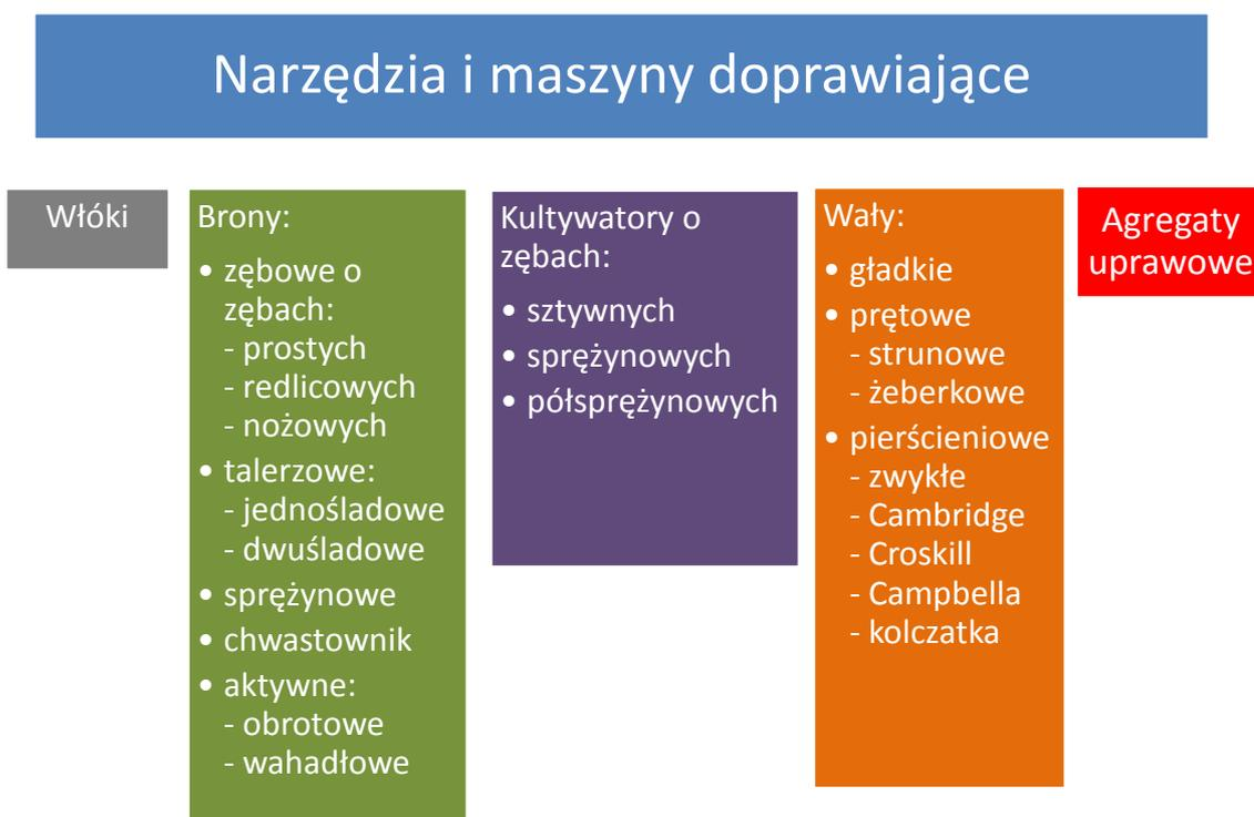
**Rys. 2.10 Klasyfikacja narzędzi i maszyn do doprawiania gleby.**
