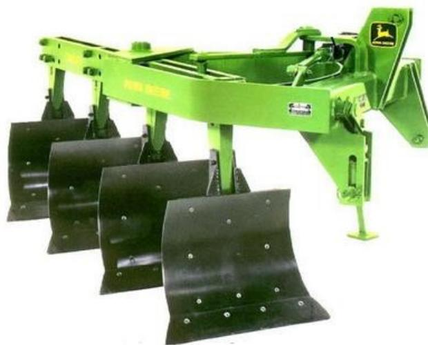
**Rys. 2.3 Pług wahadłowy 4-skibowy zawieszany firmy John Deere.**
