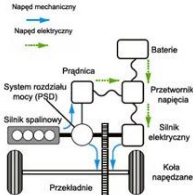
Rys. 8.7. Układ mieszany napędu pojazdu hybrydowego
