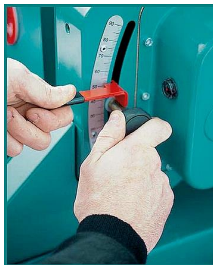
Rys. 3.7 Ustawienie przełożenia w bezstopniowej skrzyni przekładniowej w siewniku firmy SULKY
