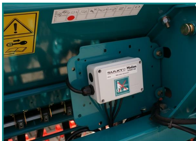
Rys. 3.12 Skrzynka rozdzielająca urządzenia elektronicznego Sulky Medion, którego jedną z funkcji jest wyznaczanie ścieżek przejazdowych
