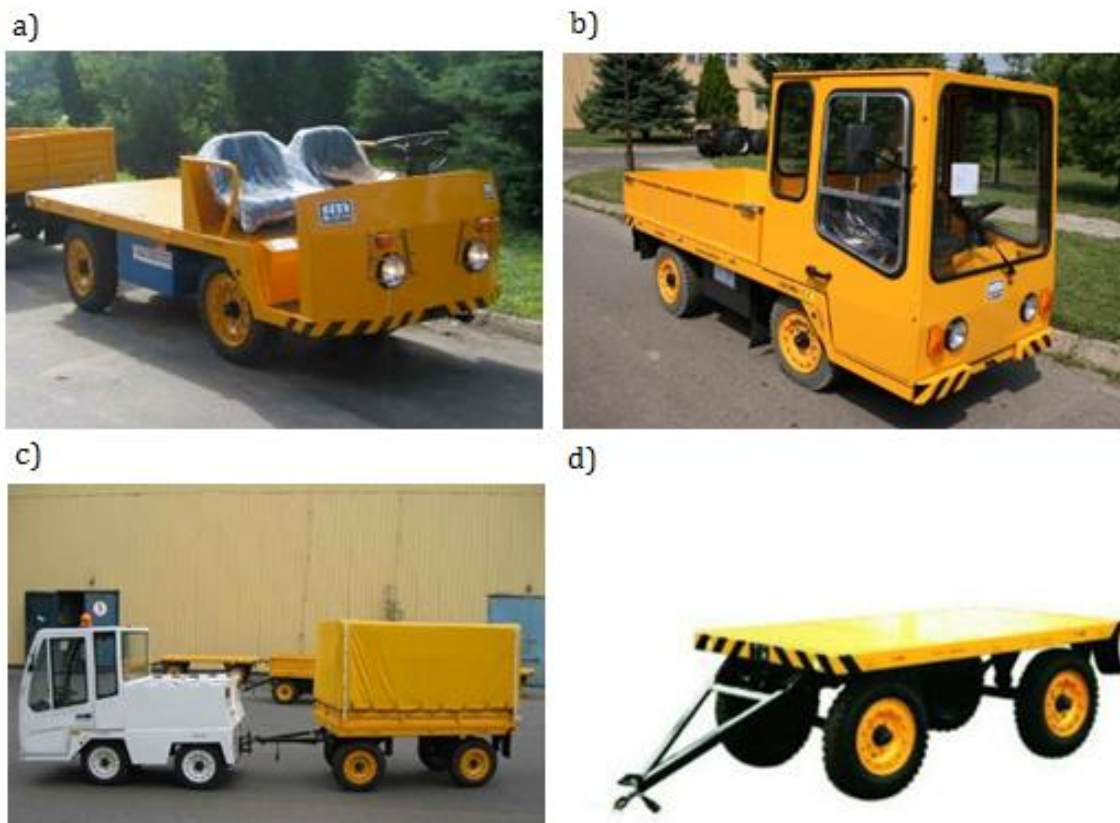
Rys. 2.15. Wózki akumulatorowe: a) platformowy bez kabiny, b) z kabiną metalową, c) z kabiną laminatową z przyczepą z burtami metalowymi i plandeką, d) przyczepa bez zabudowania.
