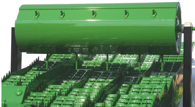
Rys. 5.27 Aktywny separator w kombajnie WTS firmy John Deere.
