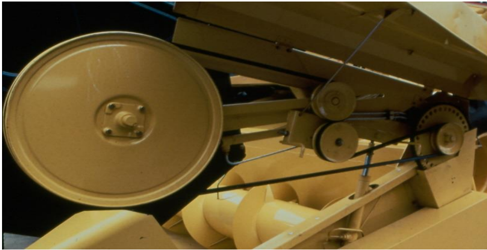
Rys. 5.9 Napęd na nagarniacz (na drugim planie widoczny podajnik ślimakowo-palcowy). Źródło: Materiały reklamowe firmy New Holland w Płocku.
