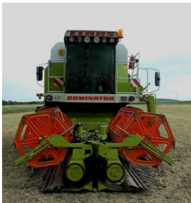
Rys. 5.11 Składany zespół żniwny kombajnu zbożowego firmy Claas. Źródło: Materiały reklamowe firmy Claas.
