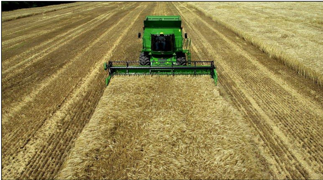
Rys. 5.32 Kombajn John Deere prowadzony przez system AutoTrac. Źródło: Materiały reklamowe firmy John Deere.
