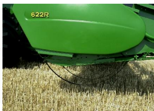
Rys. 5.13 Zasada pracy systemu HEADERTRACK firmy John Deere.
