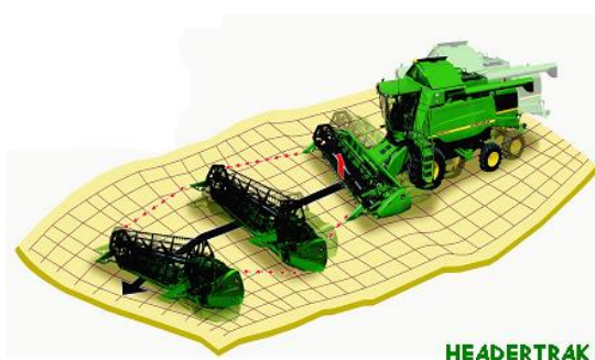
Rys. 5.13 Zasada pracy systemu HEADERTRACK firmy John Deere.
