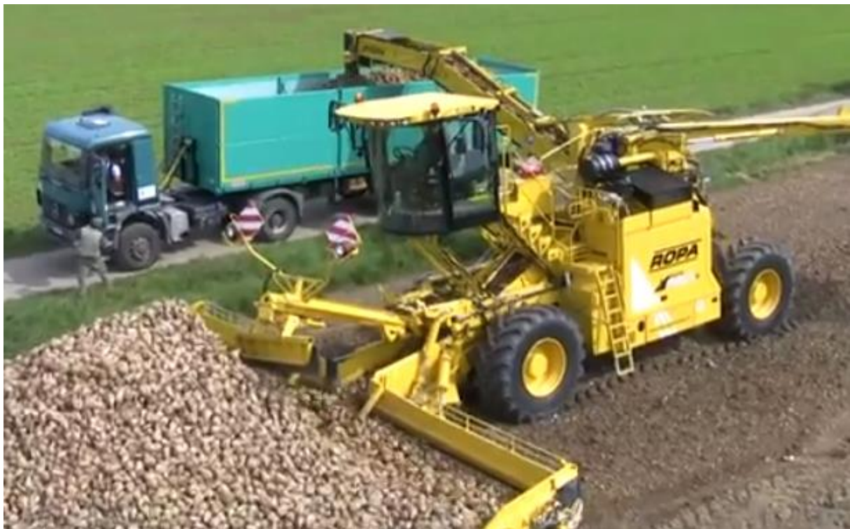
Rys. 5.57 Oczyszczarko-ładowarka ROPA Euro-Maus 4.
