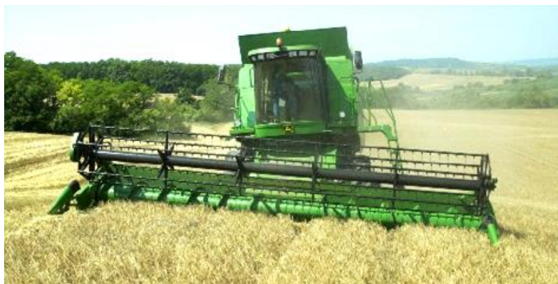
Rys. 5.30 Kombajn z systemem kompensacji pochylenia.
