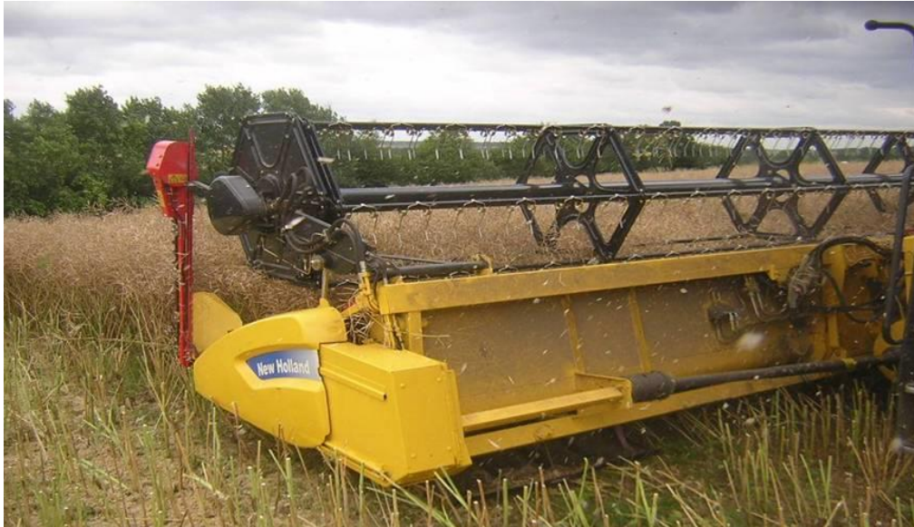
Rys. 5.8 Aktywny rozdzielacz ładu zastosowany w kombajnu New Holland.
