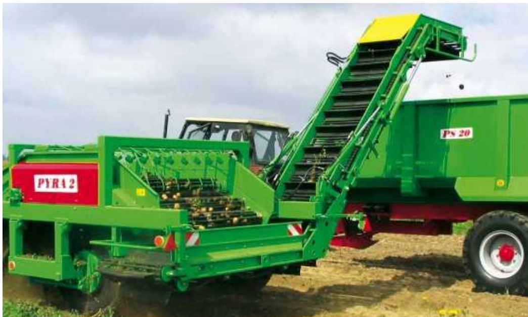
Rys. 5.49 Kombajn do zbioru ziemniaków PYRA 2 UniaGroup.
