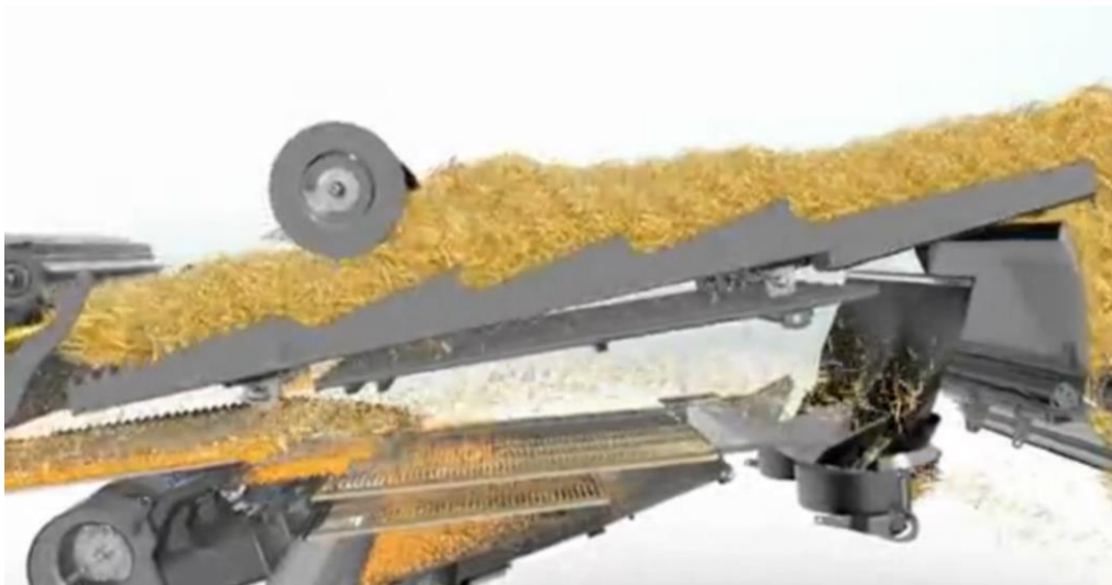
Rys. 5.22 Multifinger Separator System w Lexionie serii 600.
