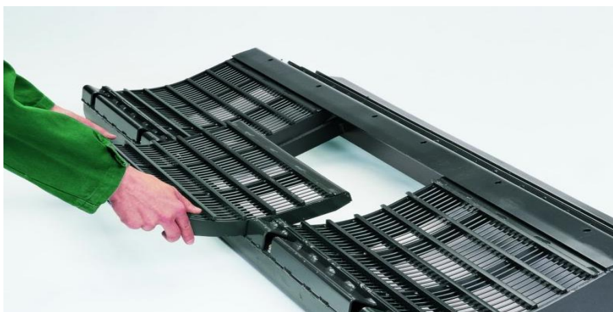
Rys. 5.18 Segmentowe klepisko w kombajnie Medion firmy Claas.
