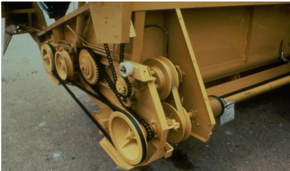
Rys. 5.7 Napęd zespołu żniwnego kombajnu Bizon New Holland TC59.
