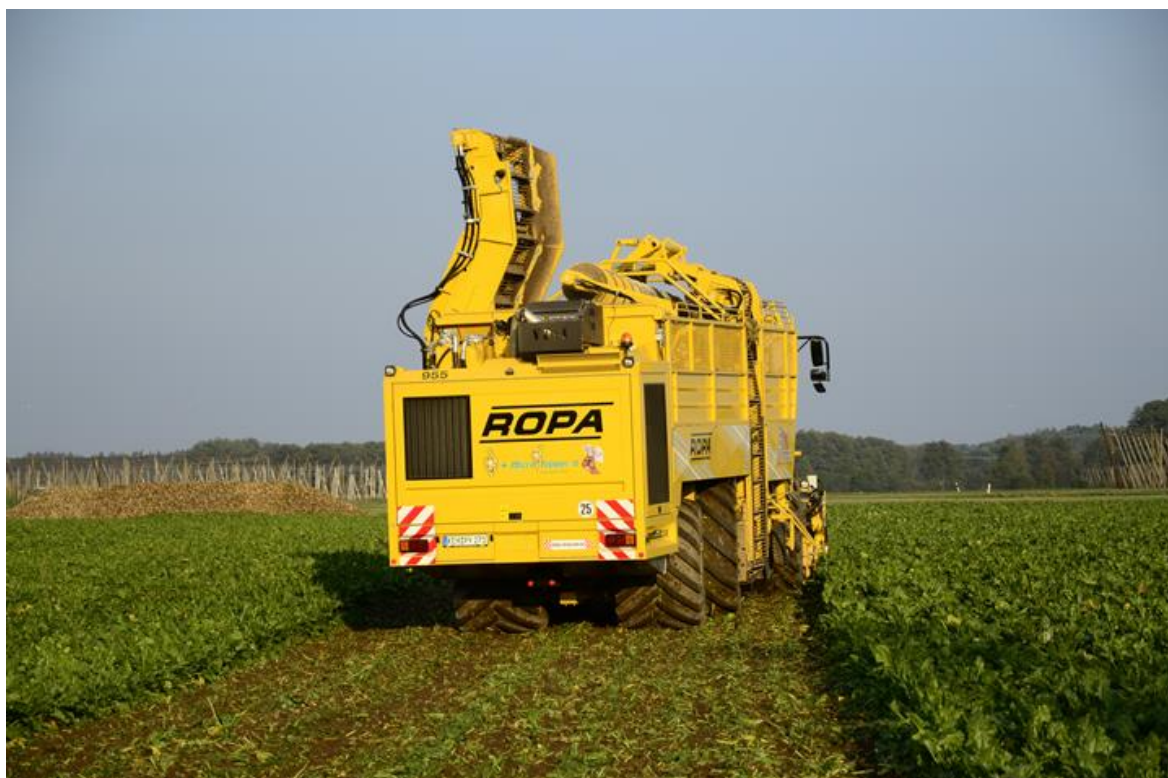
Rys. 5.54 Kombajn do zbioru buraków cukrowych Ropa euro-Tiger V-4 – jazda tzw. psim chodem.
