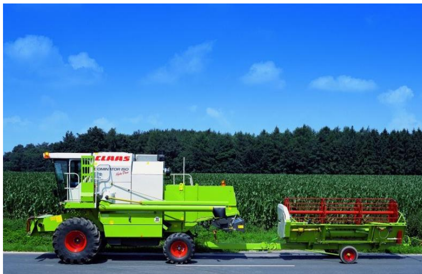
Rys. 5.10 Transport zespołu żniwnego kombajnu na wózku transportowym. Źródło: Materiały reklamowe firmy Claas.
