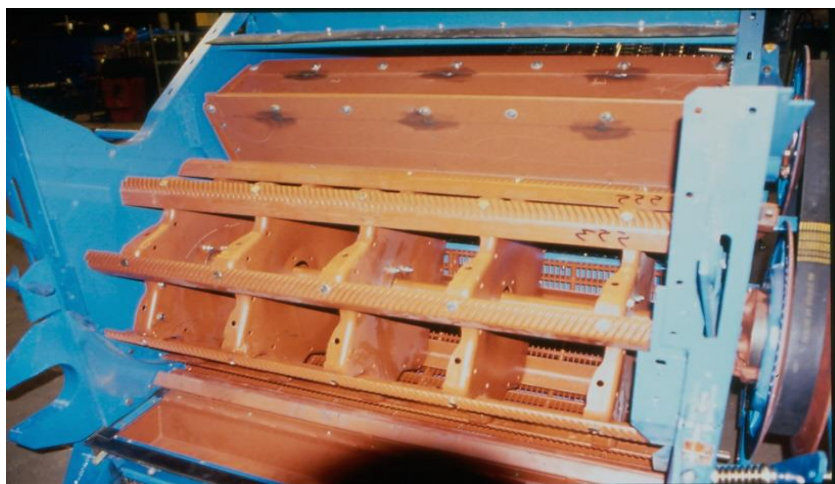
Rys. 5.14 Odślonięty zespół młocarni w kombajnie Bizon Rekord. Widoczne elementy: chwytacz kamieni, bęben młócający, klepisko i odrzutnik słomy.
