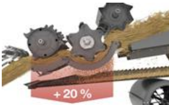
Rys. 5.16 Zespół omłotowy w kombajnie AVERO firmy Claas.
