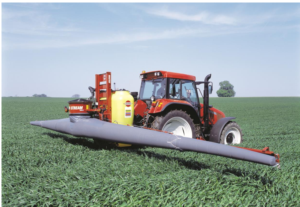
Rys. 4.7 Opryskiwacz polowy z pomocniczym strumieniem powietrza.
