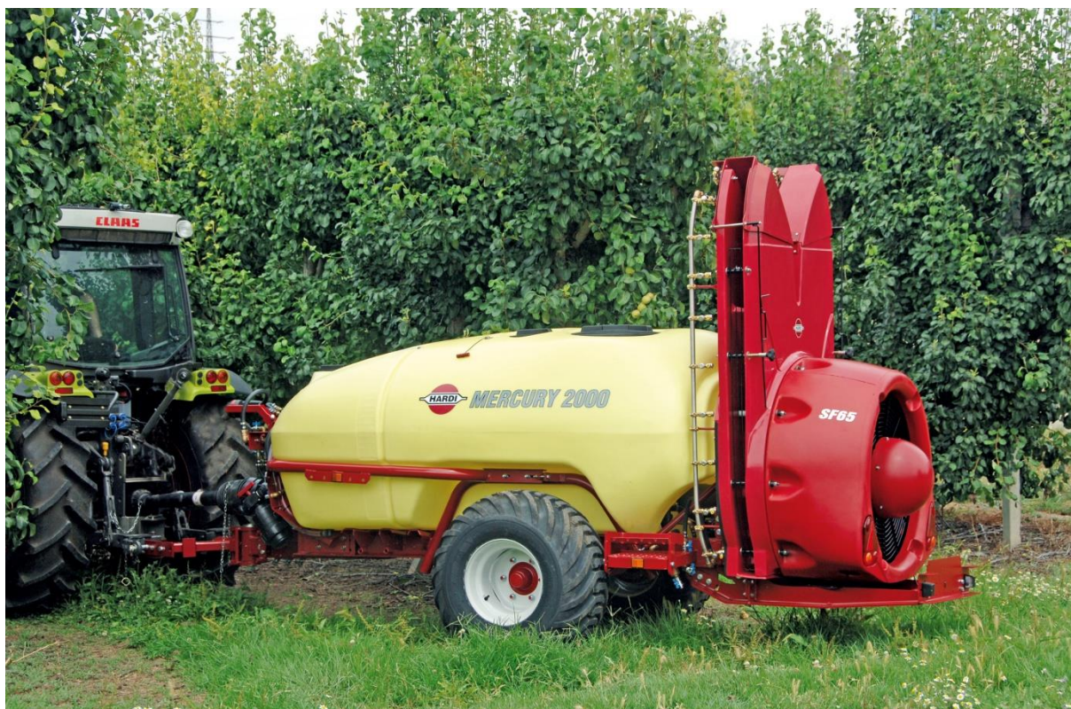
Rys. 4.8 Opryskiwacz sadowniczy z deflektorem firmy Hardi
