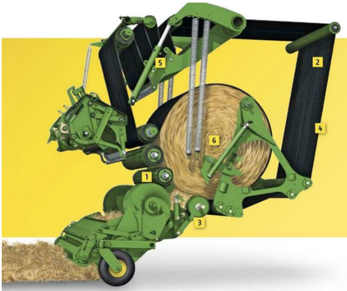
Rys. 4.24 Proces tworzenia się beli w prasie ze zmienną komorą prasowania firmy John Debre.
